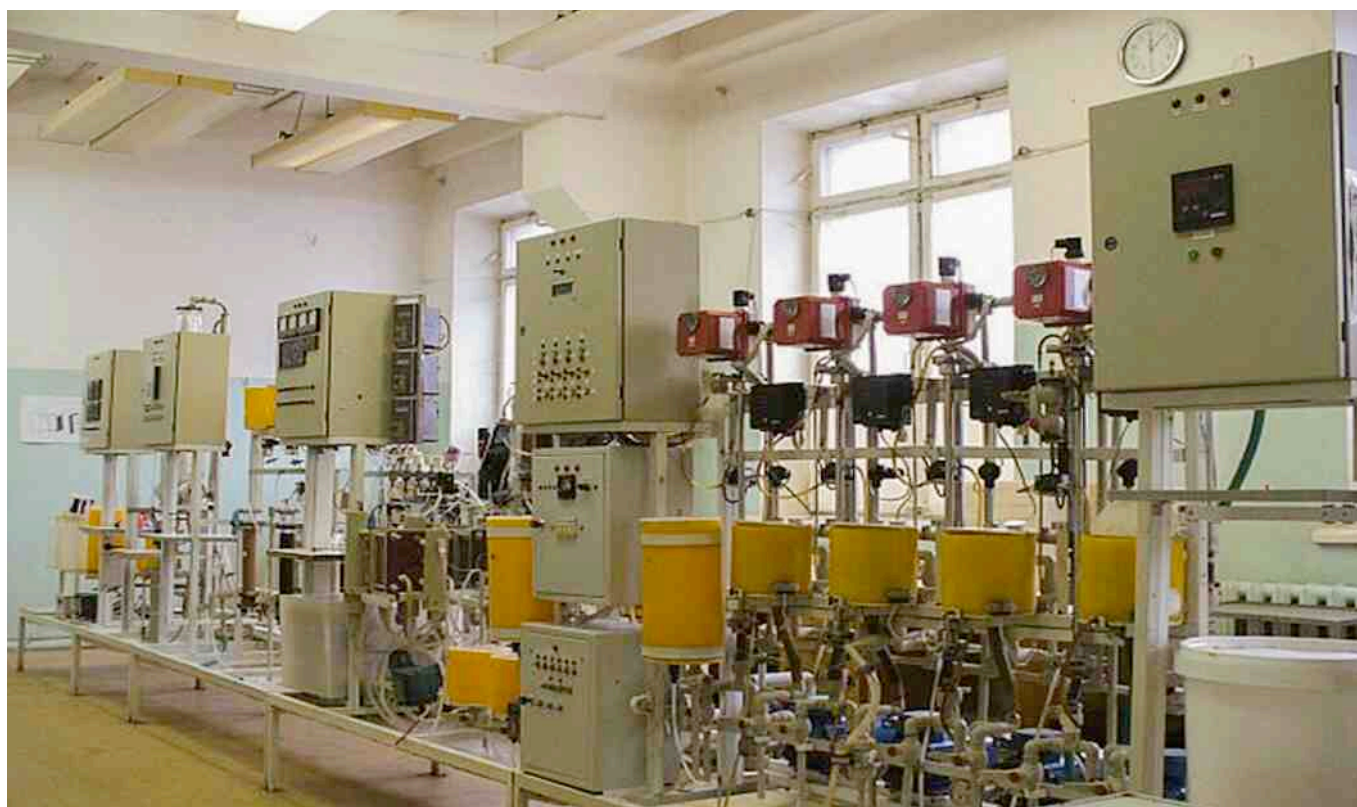
Полупромышленный стенд для отработки технологии и техники физико-химического разделения
